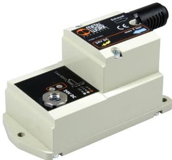
Dieses Produkt dient dazu, die Energie der Druckluft mit Hilfe einer Mikroturbine, die mit einem elektrischen Generator verbunden ist, in Elektrizität umzuwandeln. Eine interessante Anwendung der Pneumo-Power besteht darin, die Abluft von Zylindern in einem Tank zu speichern und der Pneumo-Power über ein Ventil zuzuführen, um bei Bedarf Strom zu erzeugen. Diese Anwendung ermöglicht die Rückgewinnung von Abluft, die ansonsten ungenutzt verloren ginge.
