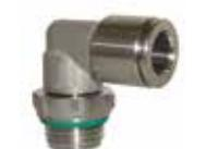
Цанговые фитинги из нержавеющей стали AISI 316, трубы диаметром от Ø 4 до 12 мм, резьба от M5 до 1/2".
